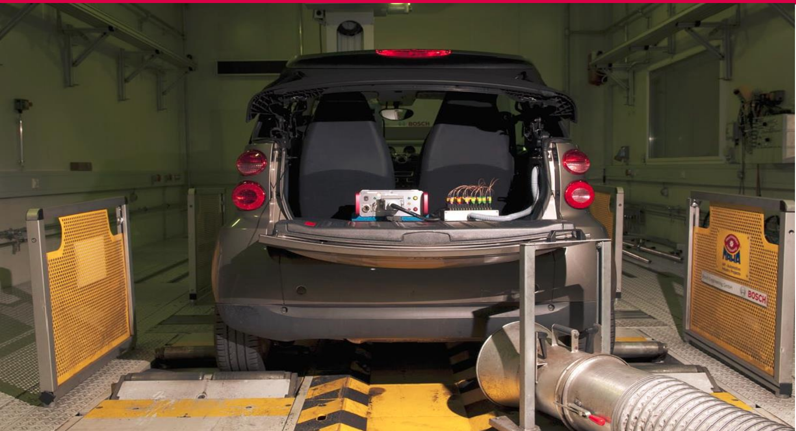
Abb. 1: Prüfstand für Kaltstartmessungen mit imc MKAS
